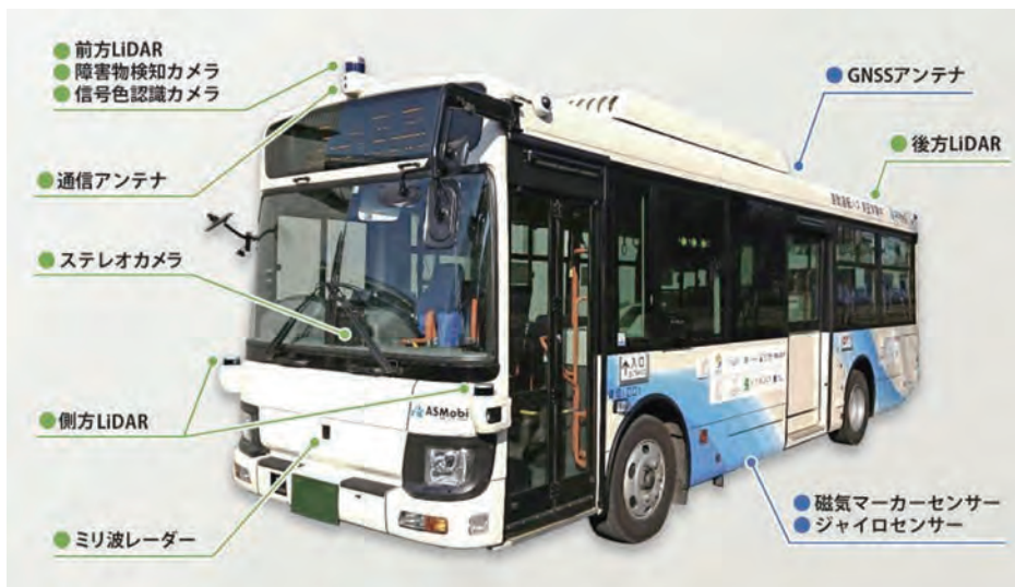
いすゞエルガミオをベースとする自動運転バス(レベル2の自動運転)。カメラやLIDARなどのセンサーを複数装備するほか、高精度の位置検出が可能なRTK-GPSや、IMU(ジャイロセンサー)、さらには路面に埋設される磁気マーカー検出用のセンサーまでもを搭載。東京大学内に設置された柏ITS推進協議会が中心となりながら、地域の自治体(柏市)をはじめ多くの企業と共同で、社会環境の検証まで含め包括的な実証実験を行なっている。
