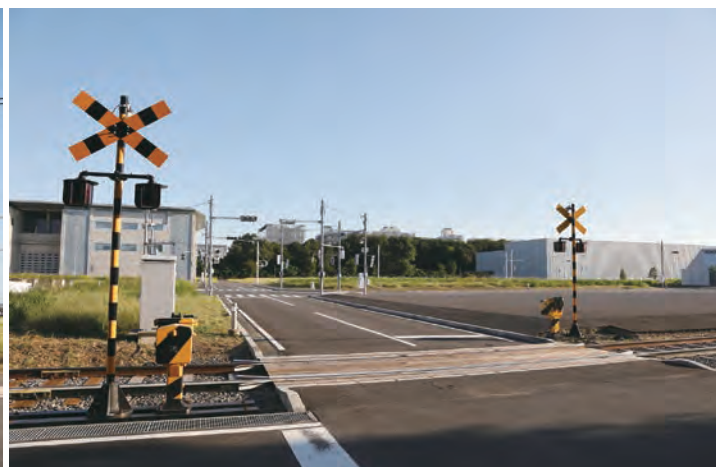
東京大学・生産技術研究所・次世代モビリティ研究センター(ITSセンター)が柏キャンパス内に設けているITS実験コース。次世代型の自律分散型交通信号システムに加え、ITS用のセンサーや通信設備などが備え付けられており、「千葉試験線2.0」と呼ばれる鉄道も敷設(なんと実際の鉄道車両も用意されている)。鉄道の敷設は大学としては国内初。パッセンジャーカーはもちろん、自動運転バスの試験も可能な規模となっており、企業の研究活動などにも広く用いられている。
